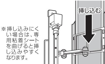
※挿し込みにくい場合は、専用粘着シートを曲げると挿し込みやすくなります。
