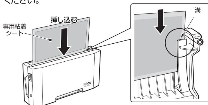
溝、挿し込む、専用粘着シート
