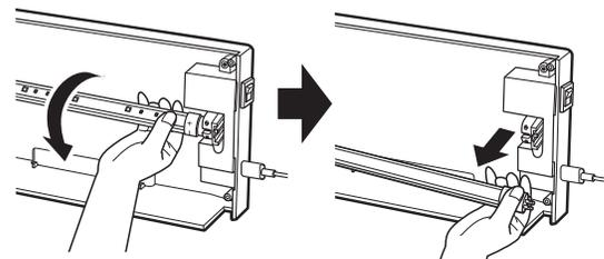
ランプの両端に手を添え、本体下部にむかって90度回し真っ直ぐに手前に引き抜きます。
